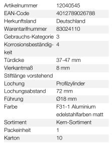
HOPPE-Aluminium-Schutz-Langschild-Paar mit Zylinder-Abdeckung für Außen-Wohnungsabschluss-Türen:
