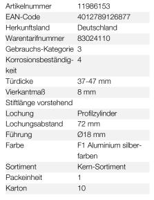
HOPPE-Aluminium-Schutz-Langschild-Paar mit Zylinder-Abdeckung für Außen-Wohnungsabschluss-Türen:
