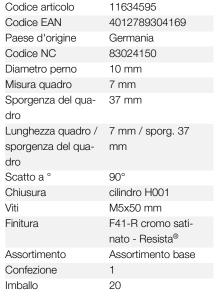
Rosetta per martellina DK SecuSelect® HOPPE in ottone con Secu100®+ Secustik® e  $\textbf{SecuTBT}^{\texttt{@}}\text{, con cilindro:}$
